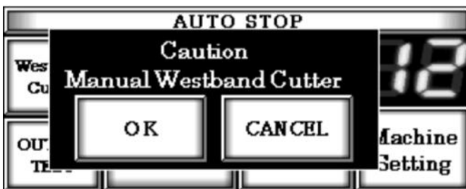
Przetącznik wykonawczy wyświetli się jak na rysunku obok. UWGA : Należy uważać, aby NIE umieszczać dłoni / palców w obszarze noża.
