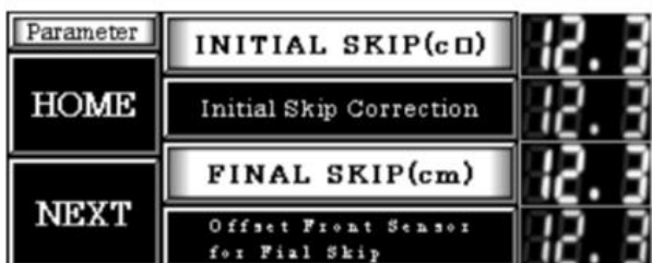
Wyświetla się ekran z parametrami. Ten ekran może zmienić długość INICJALNEGO SKIP STITCH (początkowe opuszczenia ściegów) i FINAL SKIP STITCH (końcowe opuszczenia ściegów). Ustaw początkowe i końcowe opuszczanie ściegów na tym ekranie.
